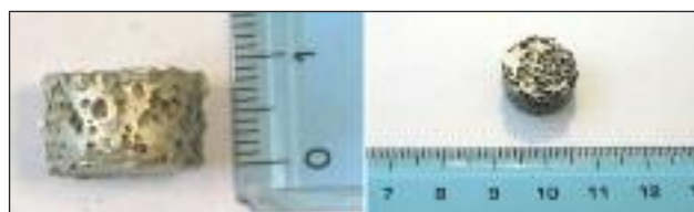
FIG. 2 Campione di schiuma di Al prodotto con metodo SDP (Al - 50% vol. urea).
