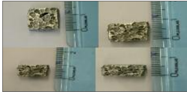
FIG. 1 Sezioni di una schiuma ottenuta con composizione: 2.8% SiC e 0.4% TiH_2 sottoposta a prove di compressione a successivi step di deformazione imposta.
