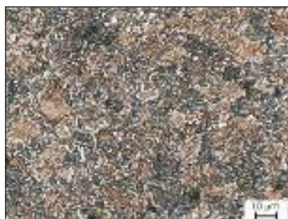
FIG. 10 x1000 LOM QP2. Attacco con reattivo De: in bianco la martensite lath, blu ferrite, marrone austenite.
