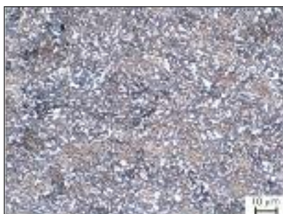
FIG. 9 x1000 LOM QP2. Attacco con reattivo Le Pera: in bianco la martensite lath, blu ferrite, marrone austenite.
