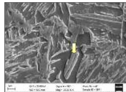
FIG. 26 20000x SEM SE QP3, Nital 0.5% e Picral 2%. "Pacchetto" di martensite ed austenite/ferrite indicato dalla freccia gialla. 20000x SEM SE QP3, 0.5% Nital e 2% Picral. Yellow arrow indicates a "packets" of martensite and austenite/ferrite.
