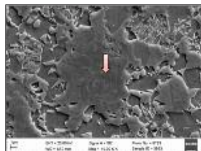
FIG. 17 10000x SEM SE QP1, Nital 0.5% e Picral 2%. Placche di austenite ad avanzato grado di trasformazione, particolare indicato dalla freccia rossa.
