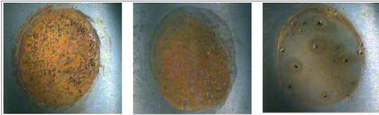
FIG. 10 Superficie dei campioni nitrocarburiati dopo polarizzazione (8x).
