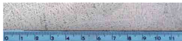
Fig. 3 - Macrografia a cuore lingotto 26NiCrMoV11.5
