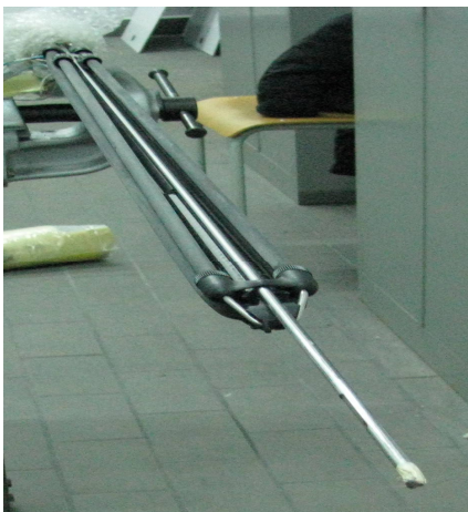
Figura 4: Arbalete con testata chiusa. Figure 4: Speargun with standard muzzle.
