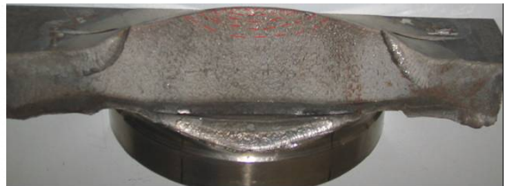
Figura 6. Superficie di frattura dell'albero a gomiti.
