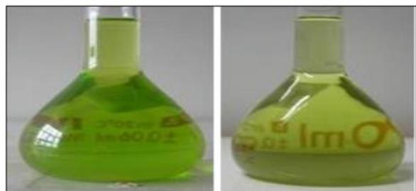
Gambar 7. Foto warna larutan pigmen klorofil Lamun sebelum iradiasi sinar polikromatik (kiri) dan setelah iradiasi sinar polikromatik (kanan) selama 7 jam
