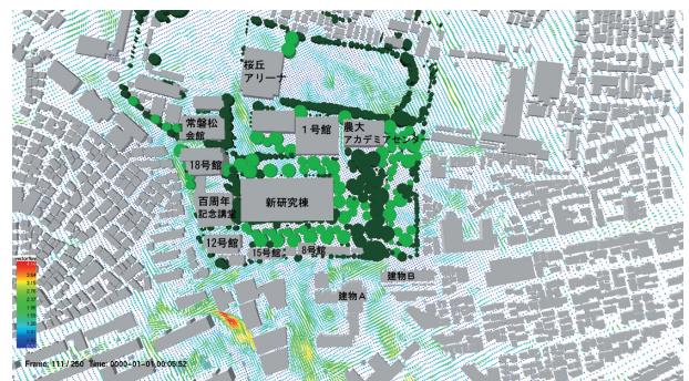
図 23 北北西 3.4 m/s の風の流れ (計画建物・計画樹木) シミュレーション風速結果：最小 0.03 m/s 最大 4.16 m/s
