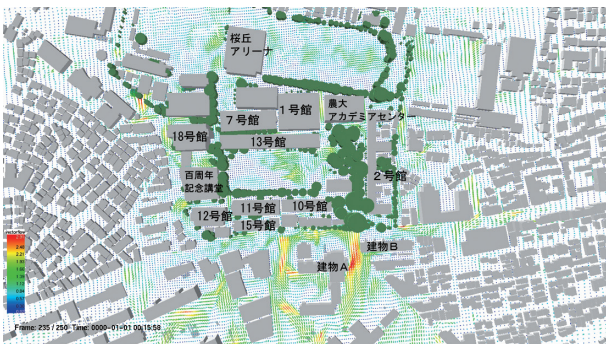
図 11 南風 2.6 m/s の風の流れ (現況建物・樹木) シミュレーション風速結果：最小 0.02 m/s 最大 2.91 m/s
