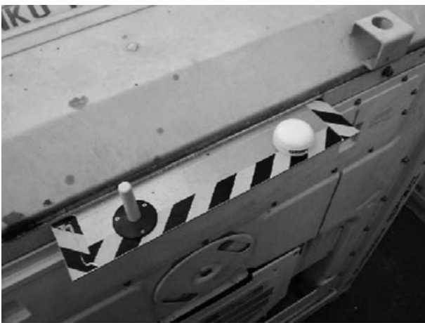
(b) コンテナ外部のアンテナ設置 (左: イリジウム, 右: GPS)
