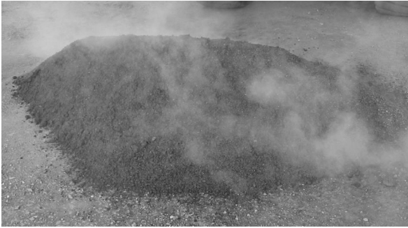
写真1 製造直後のセミホット型アスファルト混合物 (写真の白煙は、水蒸気)
