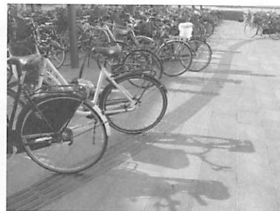
図 27 歩道上のS字になった点字ブロック（自転車が覆い被さっている）
