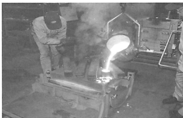
図8 凍結鑄型への注湯状況
