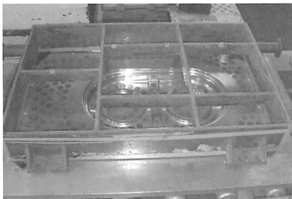
図4 鑄型枠の取り付け状況
