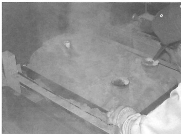
図9 鑄型の自然崩壊（水蒸気の発散）
