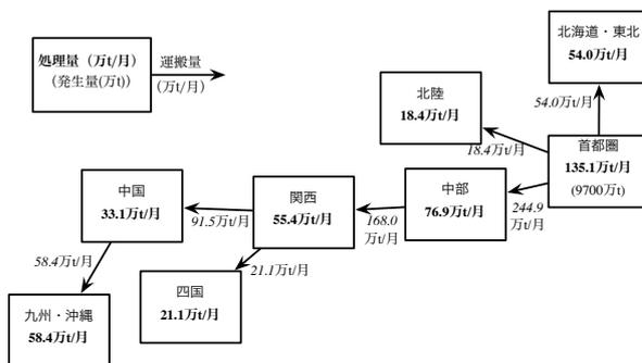
図-2 首都直下地震におけるバックヤード方式による全国連携での災害廃棄物処理方策
