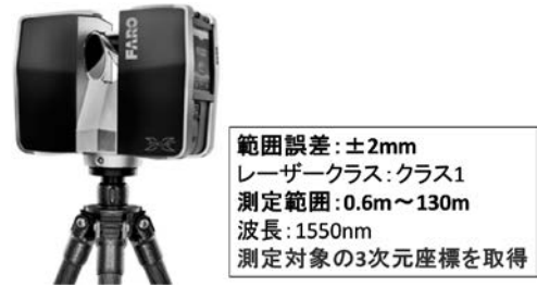
図12 3Dレーザースキャナ（FARO, Focus 3D X130）
