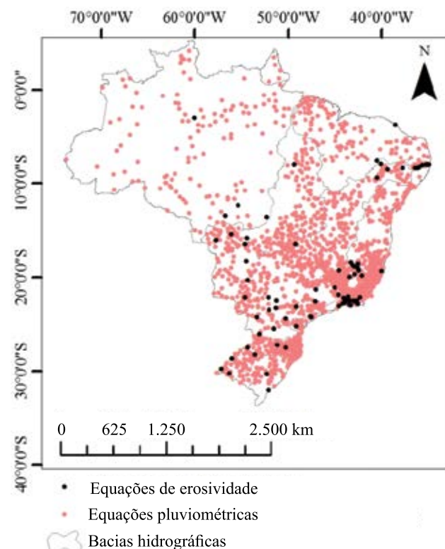
Figura 2. Estações pluviométricas selecionadas para o cálculo do índice de erosividade.
