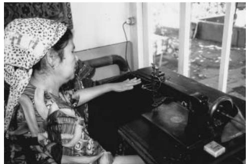
図22 1924年ドイツ製足踏みミシンを電動に改造
