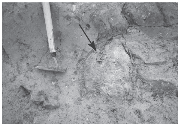
図7 花崗岩礫と周辺の陥没現象
