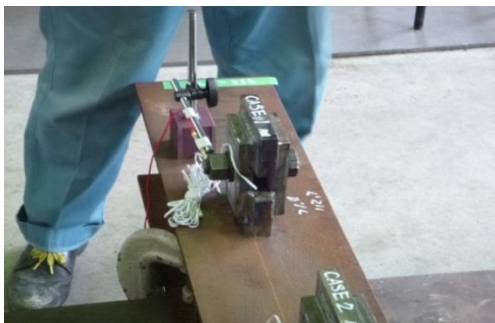
図-2 試験体設置状況 (ナット側)
