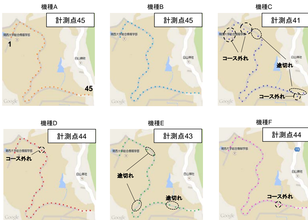
図3.10 歩行における GPS 単独実験の結果 (©2014 Google - 地図データ©2014 Google, ZENRIN)
