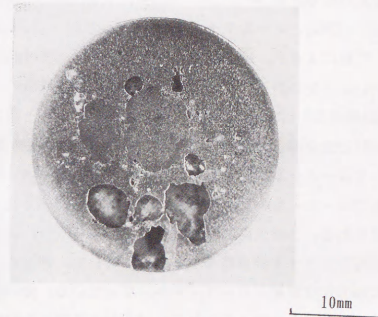
図 3-1 押湯下に現れた2種類のガス欠陥
