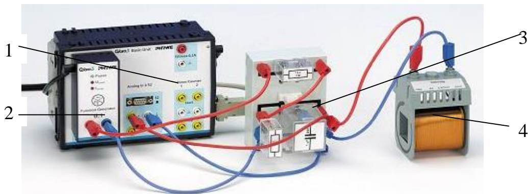
Рис. 1. Експериментальна установка: 1 – система «Кобра 3», 2 – вимірювальний модуль «Функціональний генератор», 3 – конденсатори, 4 – котушка із 300 витками
