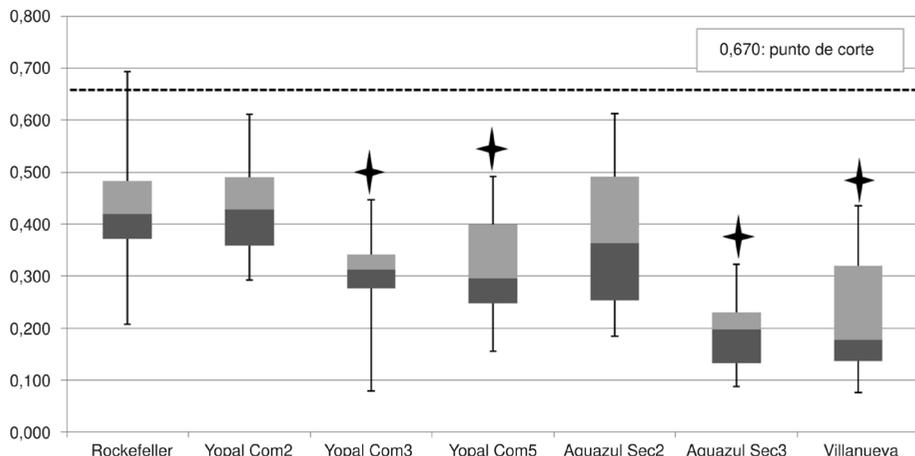
**Figura 3.** Diagrama de cajas de los valores de absorbancia para la actividad enzimática de las β-esterasas inespecíficas. Poblaciones con diferencia significativa respecto a la cepa Rockefeller de referencia marcadas con estrella.
