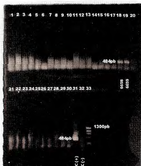
Figura 4. Reacción de PCR para enterovirus 71 utilizando los iniciadores 159-162. El marcador molecular (derecha del segundo gel) muestra bandas de ADN desde 281pb hasta 1300pb. El fragmento amplificado de 484pb correspondiente a la muestra 6658 se observa en la columna 18 del primer gel. También aparece una banda fuerte en la columna 19, que resultó ser contaminación cruzada entre las muestras 6658 y 6659. El fragmento se observa a nivel de las bandas 4 y 5 de arriba a abajo del gel. El control positivo se observa en el segundo gel, seguido del control negativo de la reacción.
