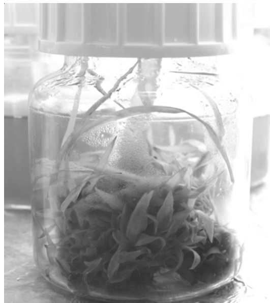
Figura 1. Plántulas de caña de azúcar en BIT durante la fase de elongación sometidas a condiciones autotróficas
