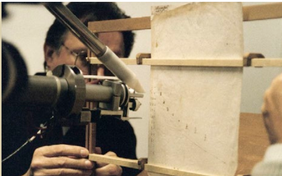
Fig. 2. Uno dei fogli del Ms. Gal. 72 mentre viene piazzato sul punto di misura per l'analisi PIXE dei suoi inchiostri Fig. 2. One of the folios of Ms. Gal. 72 being placed in the measurement position for the PIXE analysis of the ink.
