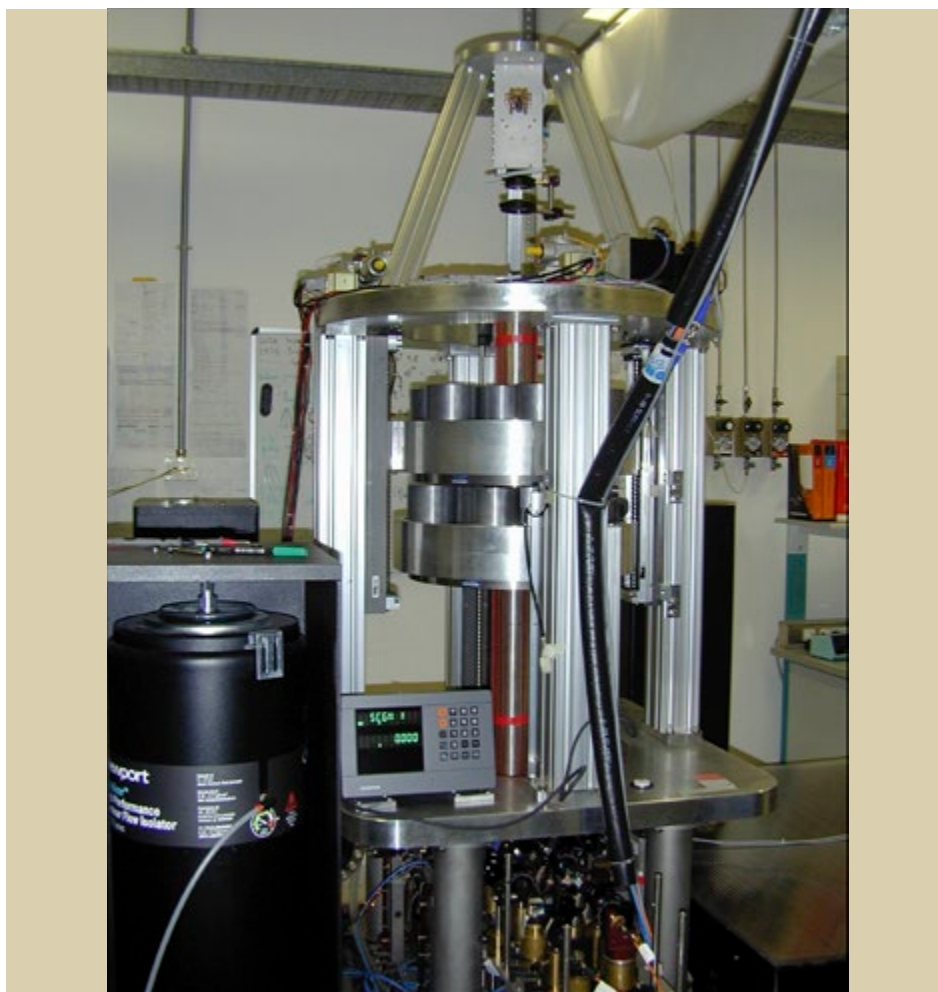
Figura 1. L'apparato per l'esperimento MAGIA. Al centro è visibile il tubo verticale in cui si è realizzata la fontana atomica e l'interferometro atomico e, intorno a questo, i cilindri di tungsteno utilizzati come massa sorgente. Figure 1. The apparatus for the MAGIA experiment. Visible in the center is the vertical tube in which the atomic fountain and the atom interferometer were created and, around this, the cylinders of tungsten used as a source mass.
