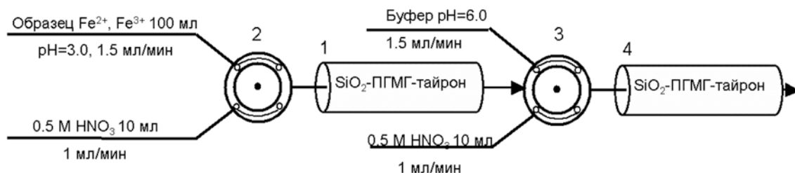
Рис. 7. Схема разделения и определения Fe(III) и Fe(II) с использованием двухклоночного варианта: миниколонка (1, 4), кран (2, 3)
