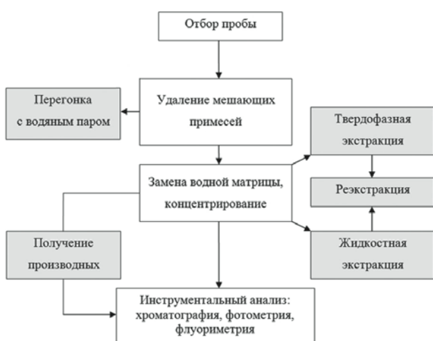
Рис. 3. Основные операции, применяемые в аналитическом цикле определения фенола в воде инструментальными методами.
