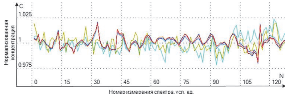
Рис. 11. Зависимость отношения измеренной концентрации Fe к аттестованному значению концентрации от номера измерения спектра, регистрируемого каждые 3 минуты в течение 6 часов со временем интегрирования спектра 10 с.
