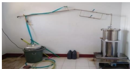
Gambar 1. Alat ekstraktor minyak atsiri Jeruk Kalamansi
