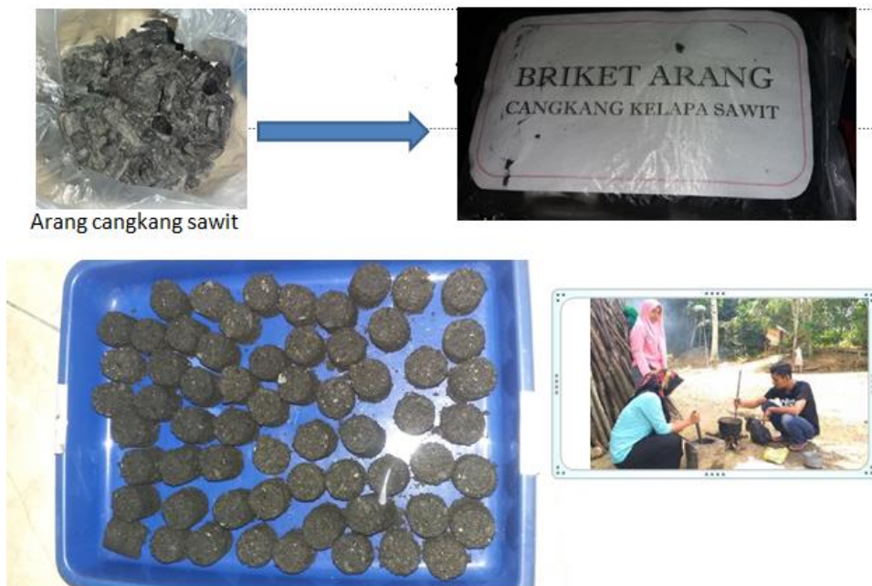
Gambar 4. Skema pembuatan briket dari arang cangkang kelapa sawit
