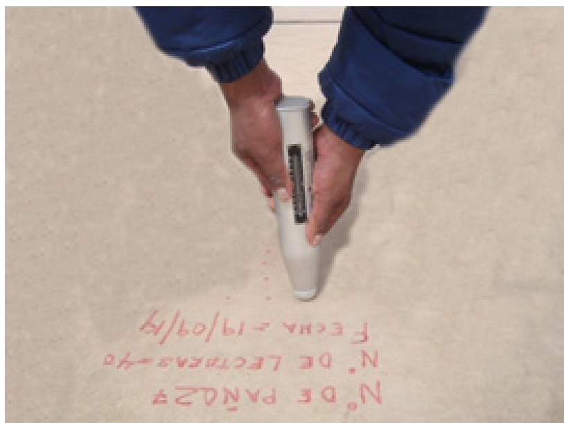
Figura N° 1. Representación de ensayo con el martillo de rebote
