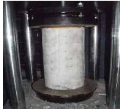
Set-up pengujian tekan beton
