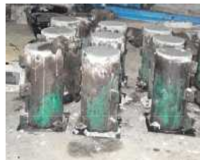
Sampel beton yang sudah dicetak
