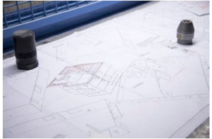
06 | Disegni esecutivi di un progetto, che permettono all'operatore di controllare in officina il processo di taglio a misura di solai e pareti con macchinari a controllo numerico. Archivio LignoAlp Working drawings enabling for cutting floors and walls to size by using numerical control machines. Courtesy of LignoAlp Archives.
