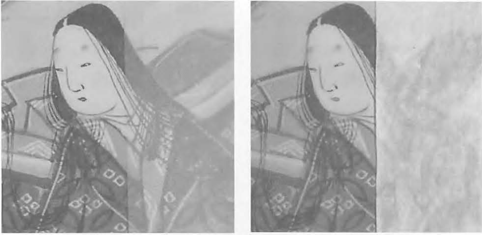
図2. 基底材の透過性の比較 (左) フィルムシート (右) 薄手の和紙 (薄美濃紙: 15.1g/m 2 )
