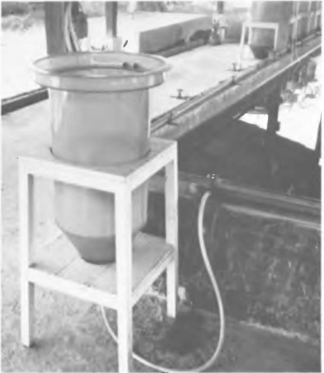
Un type d'incubateur simple à remontée d'eau, utilisé pour les oeufs de carpes en Thaïlande. (Photo : W.H.L. Allsopp)
