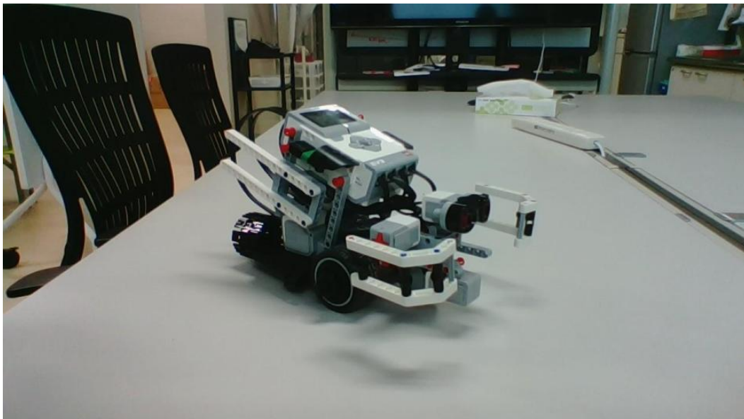
図 5.2-3 マインドストームレゴを使って、ラインコントロールした例
