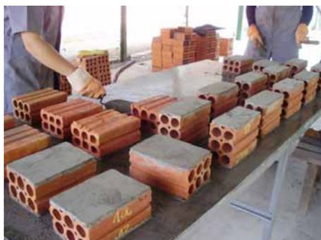
**Figura 16** – Blocos submersos por 24 horas.
