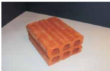
Foram verificados se estas se enquadram nas normas técnicas, sendo realizados os seguintes ensaios: 13 amostras para verificação dimensional, planeza das faces e esquadro, 6 para absorção e 13 amostras para o teste de resistência à compressão.
