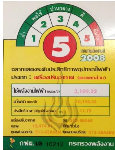
ภาพที่ 1 ฉลากแสดงระดับประสิทธิภาพของเครื่องปรับอากาศที่ใช้ทดลอง
