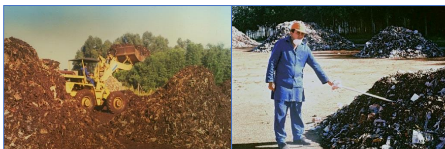
Figura 3 – Compostagem: dimensões das leiras, reviramento e monitoramento - 1989
