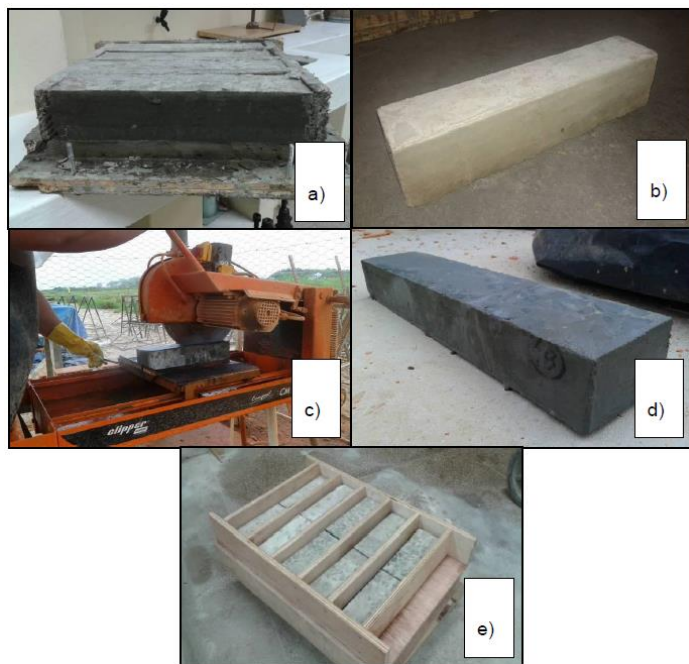
Figura 1 – (a) Corpo de prova 355x100x75mm sendo desmoldado; (b) Viga 355x100x75mm totalmente desmoldada; (c) Corte dos corpos de prova em serra circular; (d) Viga 355x50x75mm, resultante do corte longitudinal da viga inicialmente concretada; (e) Vigas 355x50x75mm, cortadas transversalmente e dispostas em novas formas para lançamento do ECC.
