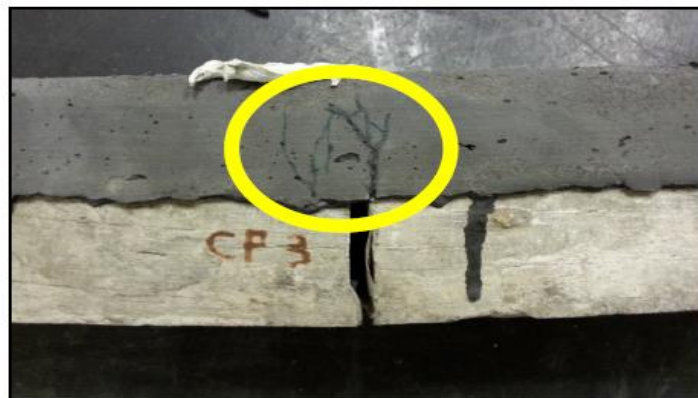
Figura 7 – Fissuração de corpo de prova composto.
