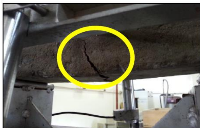
Figura 8 – Fissuração em corpo de prova de CP.
