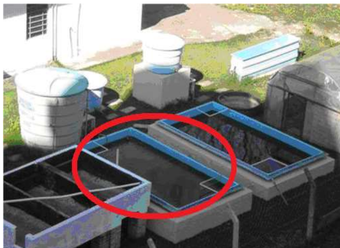
Figura 1: Sistema experimental de tratamento e polimento final de lixiviado pertencente ao Laboratório de Efluentes Líquidos e Gasosos (LABEFLU – ENS/UFSC). A lagoa onde a cepa foi isolada está demarcada em vermelho [15].
