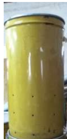
Figura 1 – Foto do reator utilizada no sistema de compostagem
