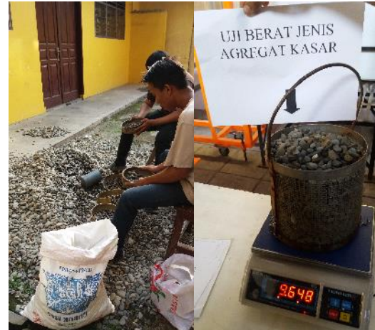
Gambar 2. Proses Pemisahan Gradasi dan Pengujian Agregat Kasar.
