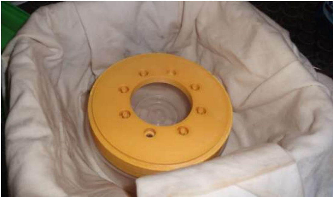
Рис. 6. Поверхностное упрочнение изделия в парах ацетона
