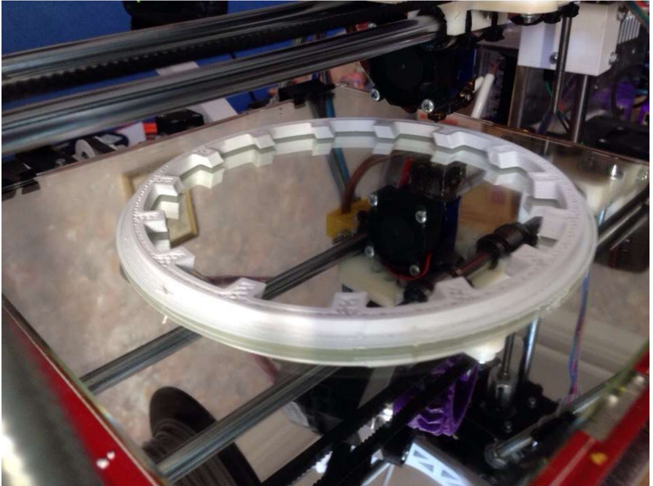
Рис. 5. Начальная стадия печати аппарата направляющего на 3D-принтере
