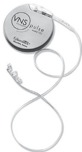
Рис. 1. Конструкция вагостимулятора: генератор импульса (содержит электронные детали и источник питания); кабель, соединяющий генератор и блуждающий нерв; электроды, прикрепляющие кабель к блуждающему нерву (источник: http://www.designntrend.com/articles/23855/20141102/graphene-chips-advance-brain-implants.htm ).
