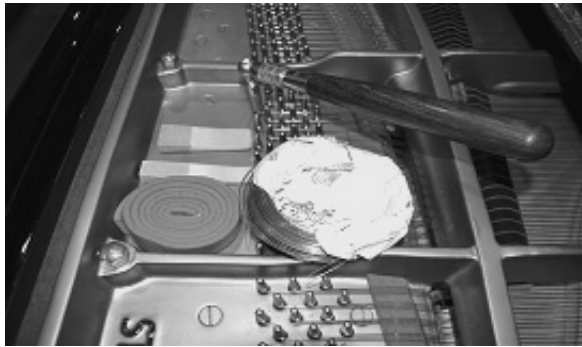
写真 1：ハンマー、弦（ピアノ線）、ウェッジ・ミュート
