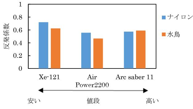
図9 斜方投射における反発係数の測定結果
