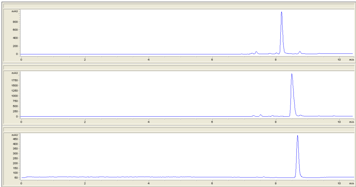
Abb. S3. HPLC-Chromatogramm des Liganden EOB-Dedpa (254nm, oben) und des Komplexes [^{nat}\text{Ga}]\text{Ga}^{\text{III}}\text{-EOB-Dedpa} (254nm, Mitte) sowie Radio-HPLC-Chromatogramm des [^{68}\text{Ga}]\text{Ga}^{\text{III}}\text{-EOB-Dedpa} (unten).
