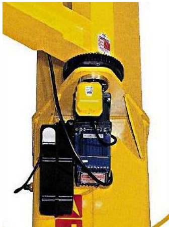
Slika 8. Rotacija granika elektromotorom i zupčastim prijenosom
